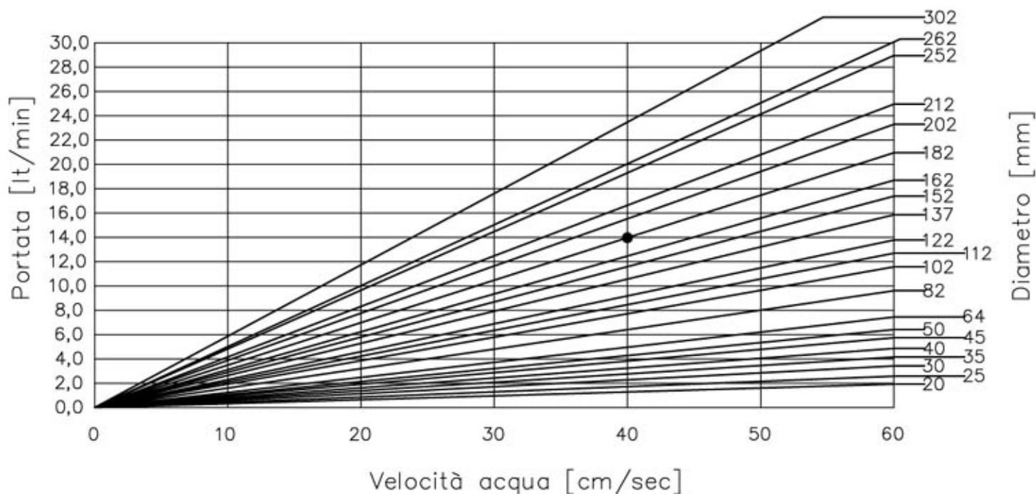
**ESEMPIO:** VIENE RICHIESTO UN FORO Ø 182 mm CON VELICITA' DI RISALITA DEL FLUIDO DI PERFORAZIONE PARI A 40 cm/sec.
