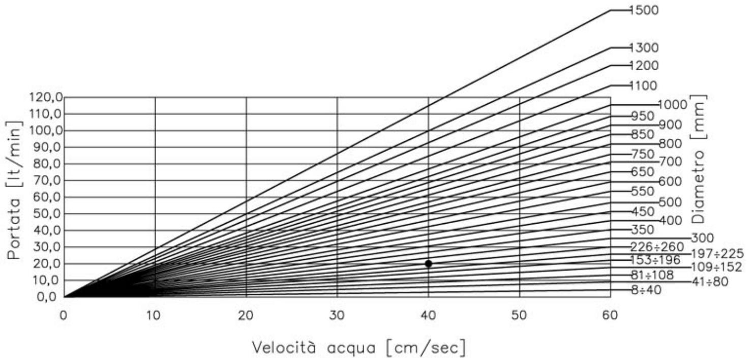
**ESEMPIO:** VIENE RICHIESTO UN FORO Ø 230 mm CON VELICITA' DI RISALITA' DEL FLUIDO DI PERFORAZIONE PARI A 40 cm/sec.
